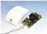
Il mouse aperto: sulle piccole schede sono ben visibili i due micro-switch corrispondenti ai tasti, il capotasto di tutto il driver personalizzato al contatto per ricevere il segnale a infrarossi della Logitech.
